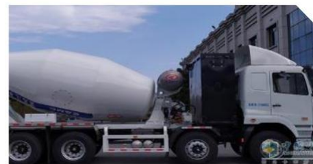
Betonkeve rő szállítójár mű
